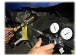
窒素ガス補充作業
