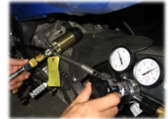
窒素ガス補充作業
