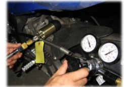
窒素ガス補充作業
