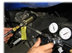
窒素ガス補充作業
